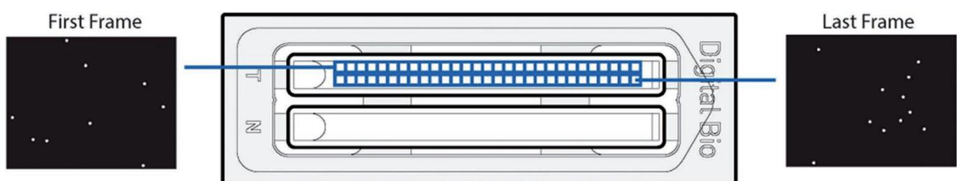
Флуоресцентный счетчик клеток Adam-MC и счетчик соматических клеток для анализа молока Adam-SCC осуществляют точный анализ благодаря использованию пропидий йодида в качестве флуоресцентного красителя и чувствительной светодиодной оптики. В ходе анализа обрабатывается от 22 до 60 изображений, получаемых благодаря движению автоматического столика относительно осей X и Y.
